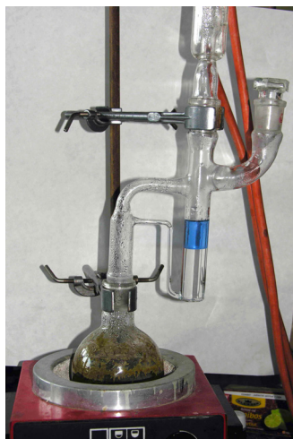
Obr. Aparatúra na prípravu a izoláciu chamazulénu z rumančekovej silice. 72
